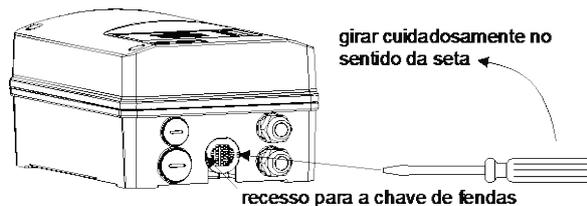
Fig. 4 Remoção do tampão do tubo de saída de ar
