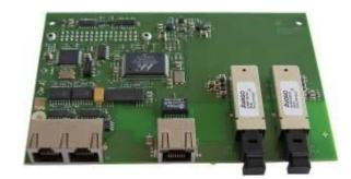
Fig. 19 B6-NET2-FXM network unit
